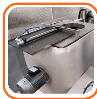
Postazione di raffreddamento ad aria ventilata Ventilated cooling air
