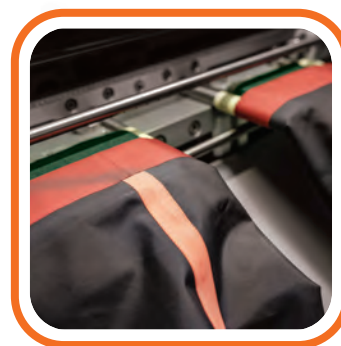
Pressatura con piastre inferiori riscaldate elettricamente e con rotazione del tubolare Pressing with lower plates electrically heated and with rotation of the tube
